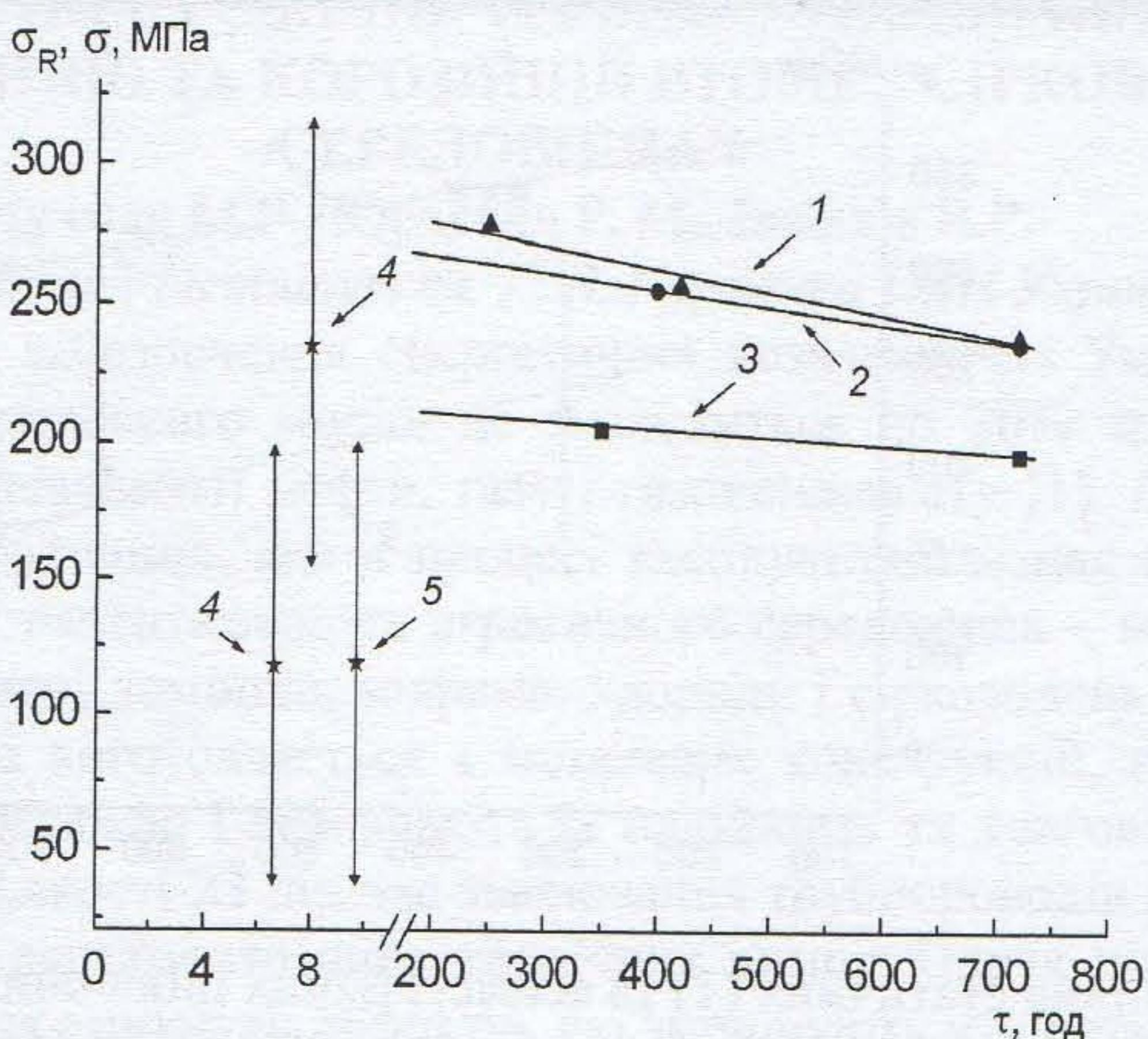
Рис.3. Вплив статичних (1-3) та асиметричних циклічних (4, 5) напружень на довговічність зварних зразків зі сталі 17Г1СУ, зварених електродами УОНІИ 13/55Р (1, 4), FOX EV 50 (2, 5) та Basic One (3) у розчині NACE ( $f = 0,5$  Гц;  $\sigma_a = 0,2 \sigma_{0,2}$ ).
