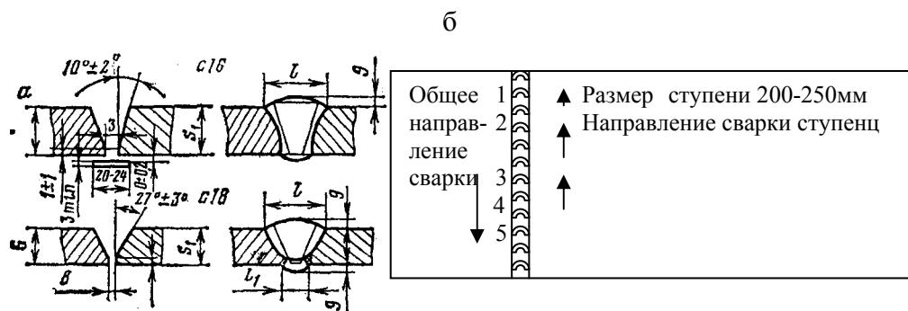
Рис.2. Конструктивные элементы стыковых швов (а) и последовательность выполнения сварного соединения (б):
