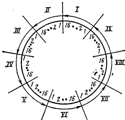
Рис. 10. Схема сварки кольцевых швов, соединяющих корпус с днищем:
