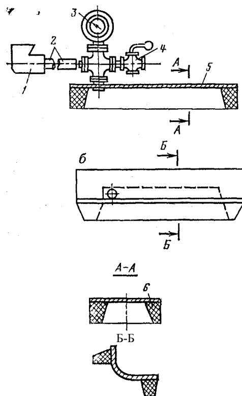
Рис. 5. Вакуумкамеры для испытания герметичности швов:
