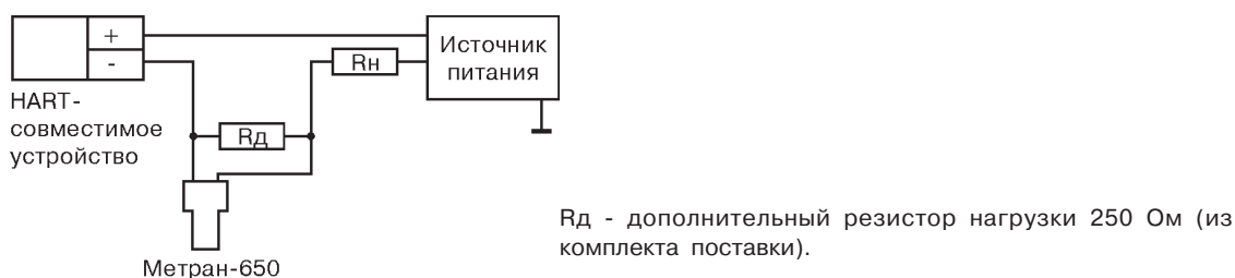
Рис.5. Подключение коммуникатора при R_n менее 250 Ом.
